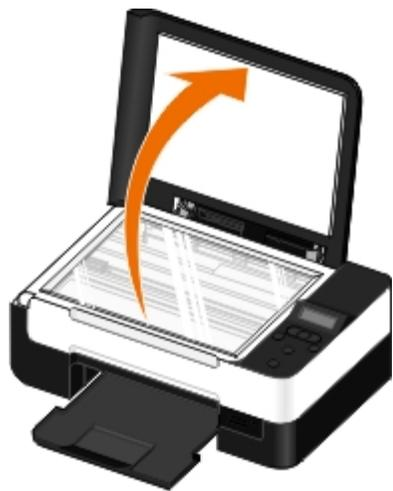
2. Legen Sie das Dokument mit der Vorderseite nach unten auf das Scannerglas.
