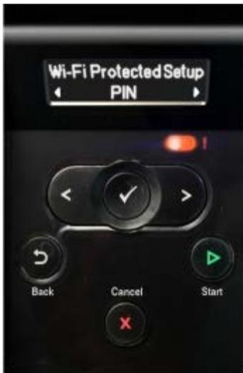
13. Geben Sie innerhalb von zwei Minuten die PIN (auf dem Bedienfeld des Druckers) auf der WPS-Seite des Routers in das Feld "PIN" ein.
