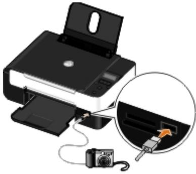
**HINWEIS:** Ist der Drucker nicht mit einem Computer verbunden, während eine PictBridge-fähige Kamera an den Drucker angeschlossen ist, sind ggf. einige Tastenfunktionen des Druckerbedienfelds nicht verfügbar. Diese Funktionen sind nach dem Trennen der PictBridge-Kamera vom Drucker wieder verfügbar.
